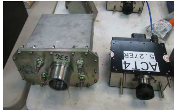
Figura 2. Los actuadores de dos generaciones del sistema activo de control de la superficie del reflector primario. Lado izquierdo - actuadores instalados en los anillos 1, 2, y 3 en 2006, fabricados por la empresa KUN. Estos actuadores, por su tamaño, no pueden ser instalados en los anillos exteriores (4 y 5), y además no cumplen con las especificaciones de precisión del diseño original. Lado derecho - la nueva generación de actuadores fabricados por la empresa ADS International que cumplen exitosamente con todas de las especificaciones de precisión y operación.
