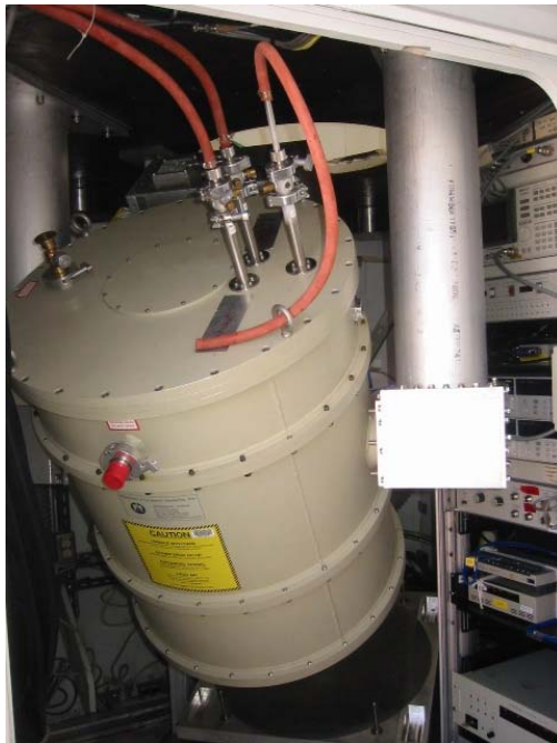
AzTEC (del inglés, Aztronomical Thermal Emission Camera ) es un instrumento de primera generación destinado para el Gran Telescopio Milimétrico, que se ha acoplado temporalmente a ASTE. AzTEC ha sido diseñado e integrado en los laboratorios de la Universidad de Massachusetts en Amherst por el Dr. Grant Wilson y su equipo.
